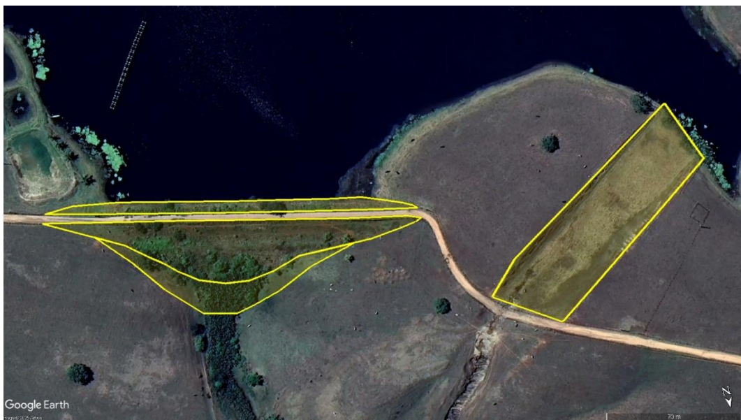
Figura 2 – Vista superior da Barragem Marcado Grande com indicação da área a ser realizada limpeza de vegetação: estrutura da barragem, área do reservatório, região a jusante, vertedouro e ombreiras.
