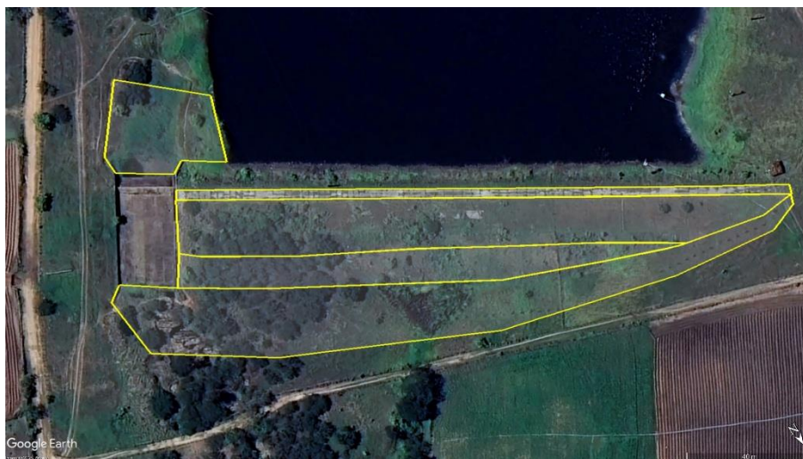
Figura 3 – Vista superior da Barragem Itapicuru com indicação da área a ser realizada limpeza de vegetação: estrutura da barragem, área do reservatório, região a jusante, vertedouro e ombreiras.
