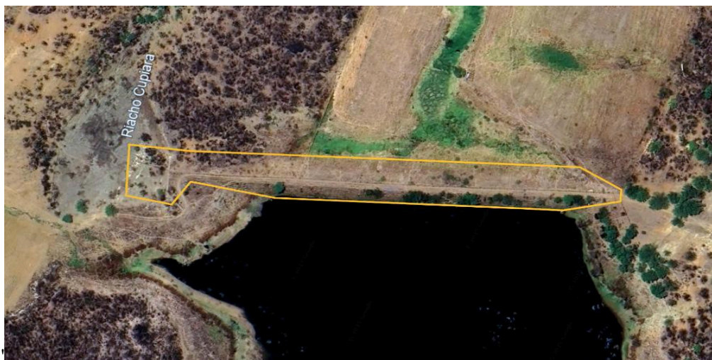
Figura 4 – Vista superior da Barragem Murici com indicação da área a ser realizada limpeza de vegetação: talude de montante, crista, talude de jusante, região a jusante e parte do canal de aproximação/restituição demarcada.
