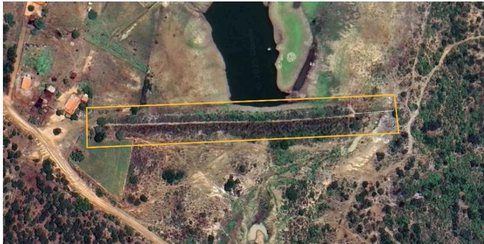
Figura 4 – Vista superior da Barragem Murici com indicação da área a ser realizada limpeza de vegetação: talude de montante, crista, talude de jusante, região a jusante e parte do canal de aproximação/restituição demarcada.
